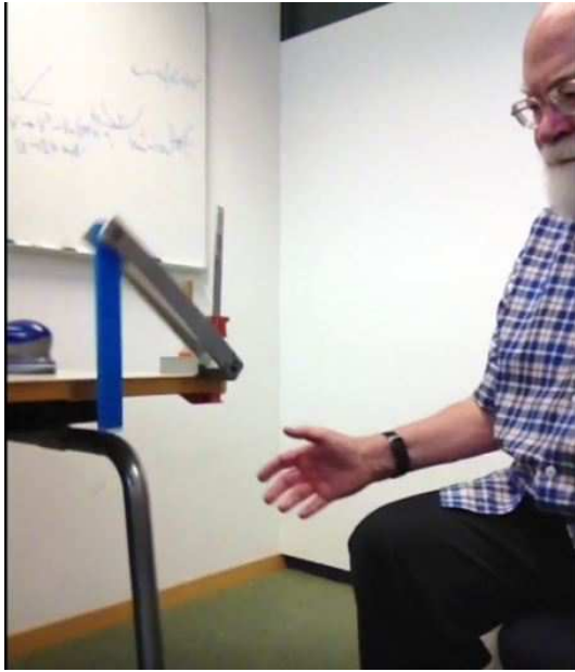
FIG. 2.— Péndulo doble en funcionamiento y que presenta una gran variedad de comportamientos, desde regulares hasta caóticos. El vídeo mostrando el movimiento de este péndulo en diferentes situaciones, se lo puede ver en YouTube (2016). Foto tomada en Dresde el sábado 8 de octubre de 2016 en el MPIPKS.
