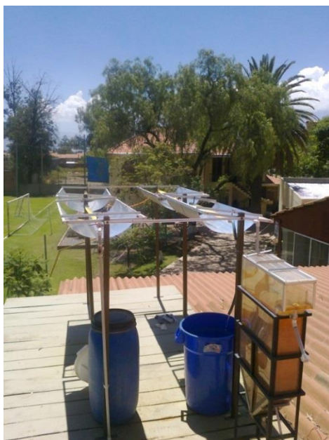
Figura 1 – Prototipo piloto del sistema de tratamiento. Foto-reactores y sedimentador.
